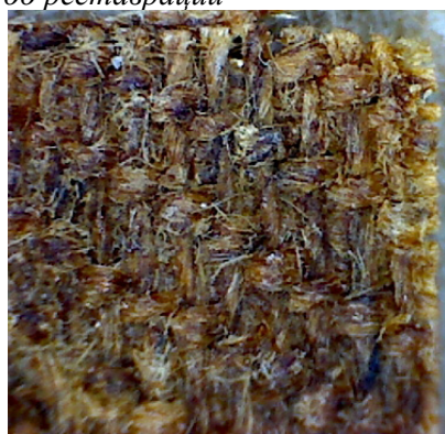
Структура авторского холста. Микрофотосъемка. Масштаб 1:160
